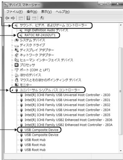
表示されていない場合は、正常に認識されていません。USBケーブルを一旦抜いてから挿しなおし、再認識させてください。
