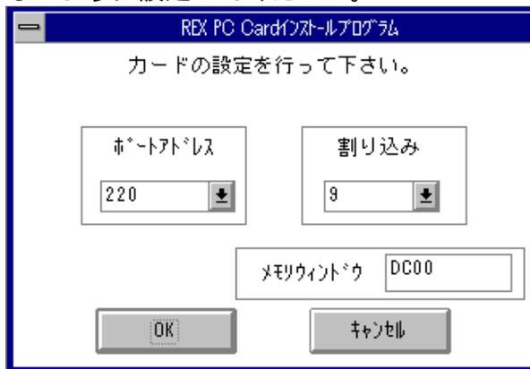
REX-5571 の場合のみ初期設定ではジョイスティックも使用するようになっているため、選択した I/O ポート以外に 201h も使用します。
